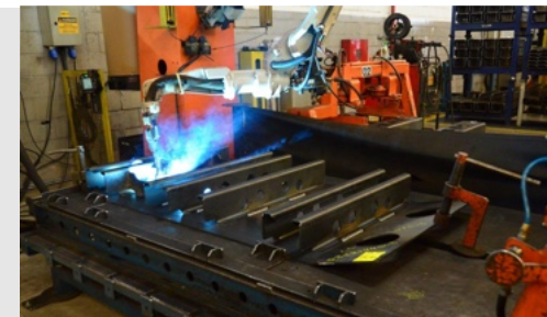
CÉLULA DE MONTAGEM COM SOLDA ROBOTIZADA
