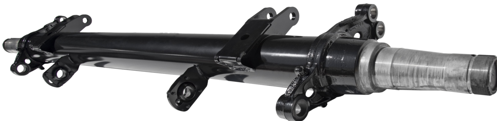
TENDÊNCIA MUNDIAL EIXOS TUBULARES FACCHINI DIÂMETRO DE 152 MM E CAPACIDADE DE 13 T. ALTA RESISTÊNCIA.
