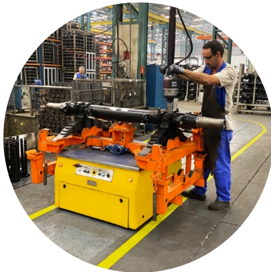
LINHA DE PRODUÇÃO DE MONTAGEM DOS EIXOS
