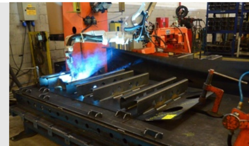
CÉLULA DE MONTAGEM COM SOLDA ROBOTIZADA
