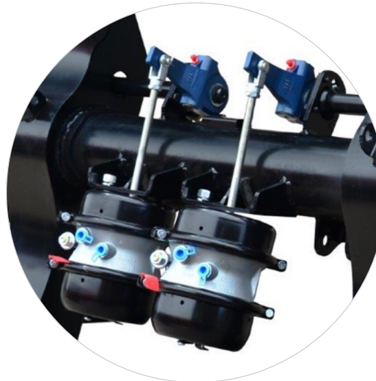
FREIO A AR, COM ABS, LINHAS DE SERVIÇO E DE EMERGÊNCIA, COM TAMBOR 16 1/2" x 8" E CÂMARA DE FREIO 30 POL 2 COM SPRING BRAKE | RESOLUÇÃO 915|22 CONTRAN
