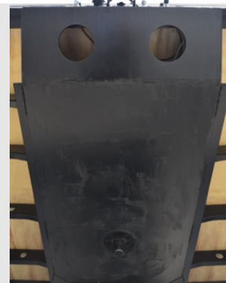
CHAPA DE ATRITO FIXADA NO CHASSI
