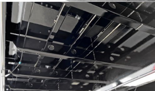
CHASSI COM LONGARINAS VIGAS PERFIL I EM AÇO DE ALTA RESISTÊNCIA MECÂNICA, TRAVESSAS PASSANTES EM PERFIL INTERLIGANDO LONGARINAS POR SOLDA ROBOTIZADA E CORRIMÃOS PERFIL LATERAL EM AÇO ASTM A36
