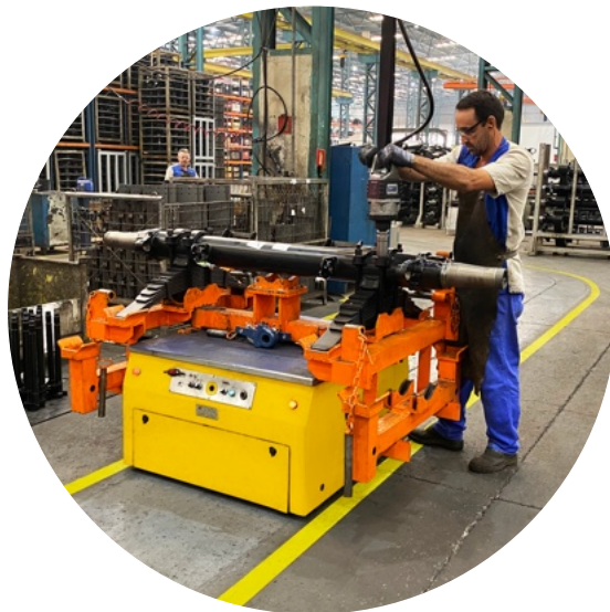
LINHA DE PRODUÇÃO DE MONTAGEM DOS EIXOS
