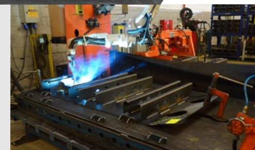
CÉLULA DE MONTAGEM COM SOLDA ROBOTIZADA
