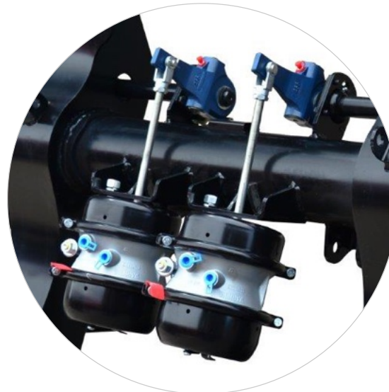
FREIO A AR, COM EBS, LINHAS DE SERVIÇO E DE EMERGÊNCIA, COM TAMBOR 16 1/2" x 8" E CÂMARA DE FREIO 30 POL 2 COM SPRING BRAKE | RESOLUÇÃO 915|22 CONTRAN
