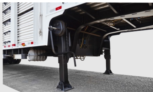
CHASSI COM LONGARINAS VIGAS PERFIL I EM AÇO DE ALTA RESISTÊNCIA MECÂNICA, COM TRAVESSAS PASSANTES PERFIL Z INTERLIGANDO AS LONGARINAS E CORRIMÃOS EM PERFIL LATERAL Z EM AÇO DE ALTA RESISTÊNCIA MECÂNICA
