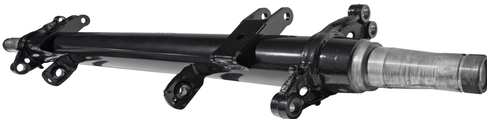
TENDÊNCIA MUNDIAL EIXOS TUBULARES DIÂMETRO DE 152 MM E CAPACIDADE DE 13 T. ALTA RESISTÊNCIA
