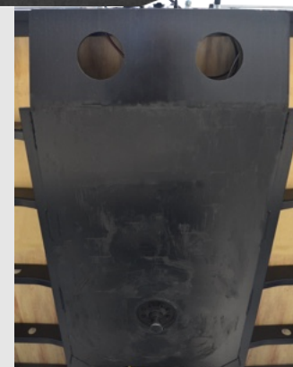
CHAPA DE ATRITO FIXADA NO CHASSI
