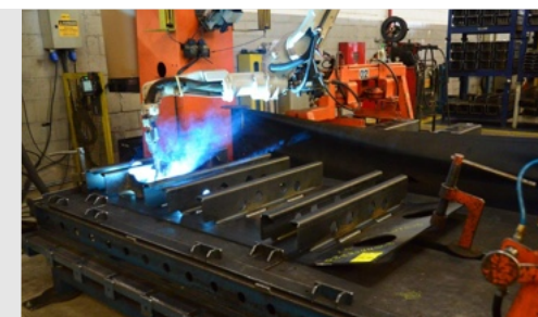
CÉLULA DE MONTAGEM COM SOLDA ROBOTIZADA
