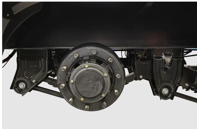
2º, 3º E 4º EIXOS COM SUSPENSÃO MECÂNICA TIPO BALANÇIM COM SUPORTES DE MOLAS ESTAMPADAS; MOLAS SEMIELÍPTICAS; BALANÇAS AÇO USI SAC 350 ARTICULADAS EM BUCHAS COM CORPO EM POLIURETANO INJETADO E TUBO CENTRAL EM AÇO. TEM COMO VANTAGENS A MAIOR ABSORÇÃO DE IMPACTOS E A ELIMINAÇÃO DA LUBRIFICAÇÃO. APOIO DAS MOLAS TIPO TROCA RÁPIDA; BRAÇOS TENSORES ARTICULADOS EM BUCHAS DE BORRACHA.
