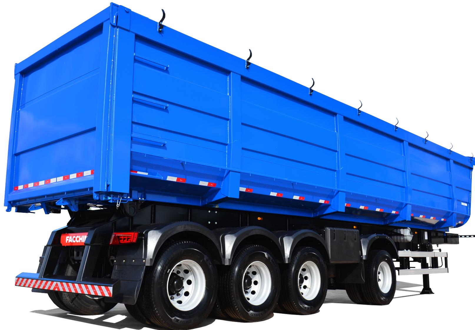
CHASSI EM AÇO ESPECIAL DE ALTA RESISTÊNCIA MECÂNICA, PROPORCIONANDO UM PRODUTO DE BAIXO PESO, ELEVADA DURABILIDADE E DE FÁCIL MANUTENÇÃO
