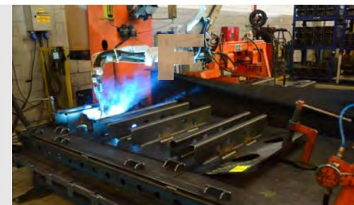
CÉLULA DE MONTAGEM COM SOLDA ROBOTIZADA
