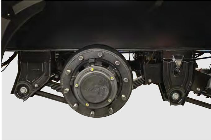
SUSPENSÃO MECÂNICA TIPO BALANÇIM COM SUPORTES DE MOLAS ESTAMPADOS; BALANÇAS AÇO USI SAC 350 ARTICULADAS EM PINOS E BUCHAS COM CORPO EM POLIURETANO INJETADO E TUBO CENTRAL EM AÇO, TENDO COMO VANTAGENS A MAIOR ABSORÇÃO DE IMPACTOS E A ELIMINAÇÃO DA LUBRIFICAÇÃO. APOIO DAS MOLAS TIPO TROCA RÁPIDA; BRAÇOS TENSORES ARTICULADOS EM BUCHAS DE BORRACHA. SUSPENSOR PNEUMÁTICO NO 1º EIXO DE CADA COMPOSIÇÃO.
