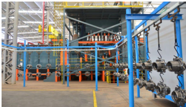
LINHA DE PRODUÇÃO DE PINTURA A PÓ AUTOMATIZADA. MAIOR DURABILIDADE, MELHOR RETENÇÃO DE COR E BRILHO.
