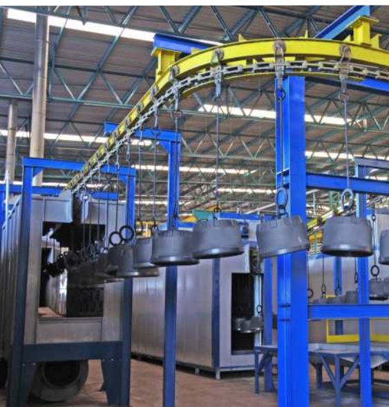
LINHA DE PRODUÇÃO DE PINTURA A PÓ AUTOMATIZADA. MAIOR DURABILIDADE, MELHOR RETENÇÃO DE COR E BRILHO.
