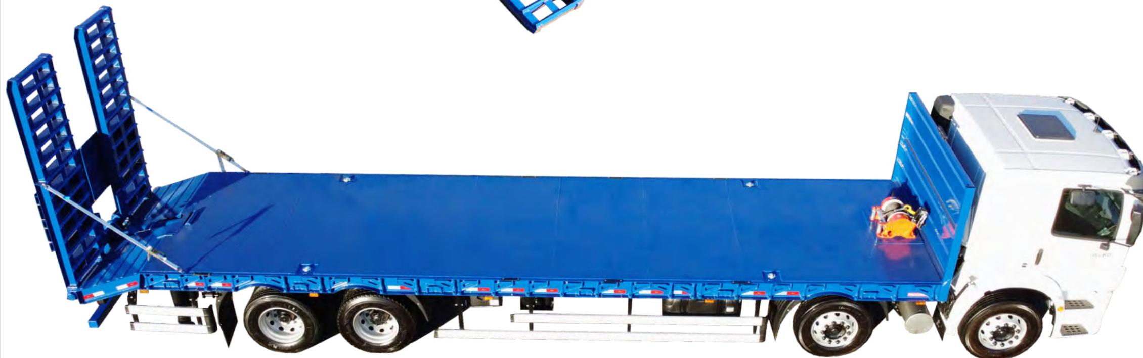
LONGARINA VIGA I, ALMA EM AÇO A36 6 MM E ABAS ½" x 3" EM AÇO A36. TRAVESSAS PERFIL C EM AÇO A36 6 MM COM MÃOS FRANCESAS LIGANDO AS LONGARINAS ATRAVÉS DE SOLDA SISTEMA MIG AUTOMÁTICO. VIGA LATERAL PERFIL C EM AÇO A36 5 MM, FECHANDO O QUADRO SOBRE AS TRAVESSAS.
