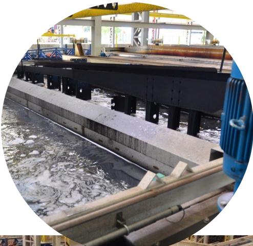
LIMPEZA COM DESENGRAXANTE QUÍMICO E FOSFATIZAÇÃO. APLICAÇÃO DE FUNDO ANTICORROSIVO COM ACABAMENTO PINTURA EM P.U. FERRAGENS DAS TAMPAS COM PINTURA ELETROSTÁTICA A PÓ.
