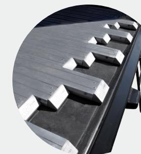
ASSOALHO PISO MÓVEL HYVA, EM ALUMÍNIO, ACIONADO POR UNIDADE HIDRÁULICA
