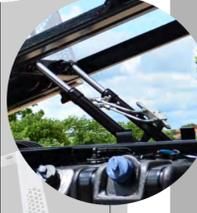
ALAVANCA PARA ACIONAMENTO DOS CILINDROS HIDRÁULICOS
