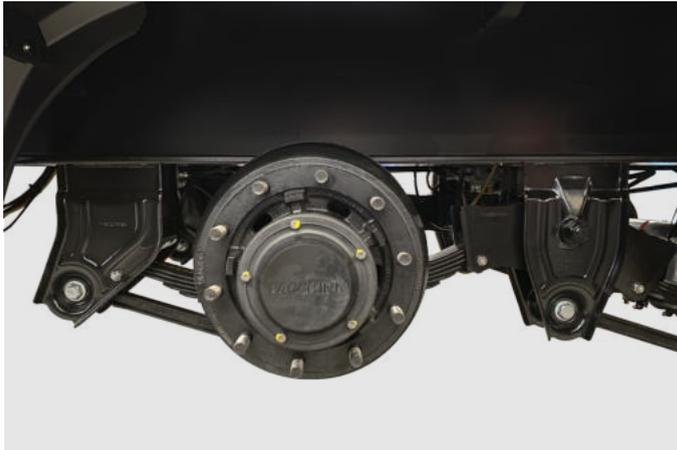
SUSPENSÃO MECÂNICA TIPO BALANÇIM COM SUPORTES DE MOLAS ESTAMPADAS; MOLAS SEMIELÍPTICAS DE 10 LÂMINAS; BALANÇAS AÇO USI SAC 350 ARTICULADAS EM PINOS E BUCHAS DE POLIURETANO INJETADO E TUBO CENTRAL EM AÇO, TENDO COMO VANTAGENS A MAIOR ABSORÇÃO DE IMPACTOS E A ELIMINAÇÃO DA LUBRIFICAÇÃO. APOIO DAS MOLAS TIPO TROCA RÁPIDA; BRAÇOS TENSORES ARTICULADOS EM BUCHAS DE POLIURETANO. SUSPENSOR PNEUMÁTICO NO 1º EIXO.
