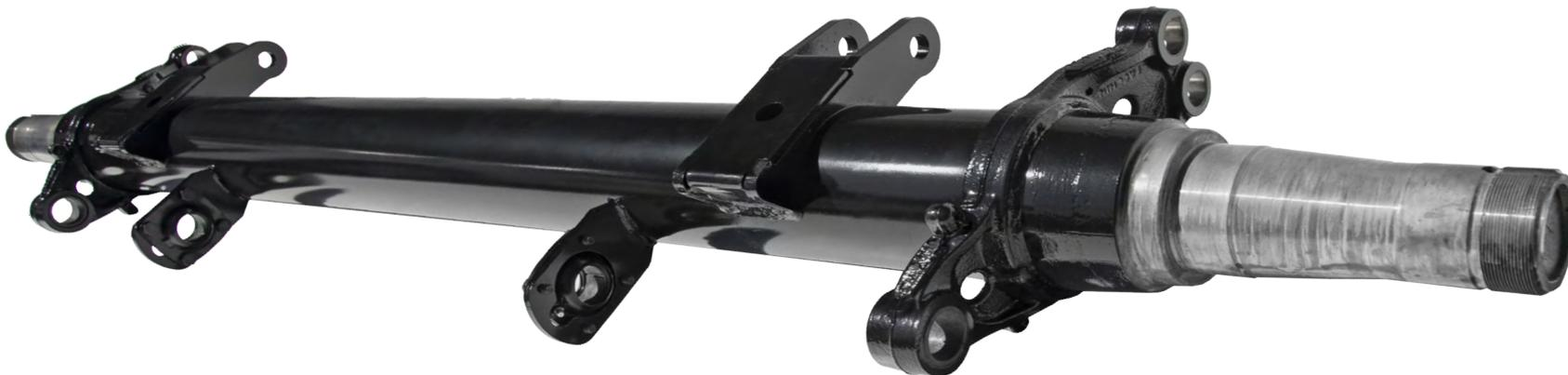
TENDÊNCIA MUNDIAL EIXOS TUBULARES DIÂMETRO DE 152 MM, PAREDE DE 11,2 MM, CAPACIDADE DE 11 T. ALTA RESISTÊNCIA.
