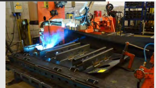
CÉLULA DE MONTAGEM COM SOLDA ROBOTIZADA
