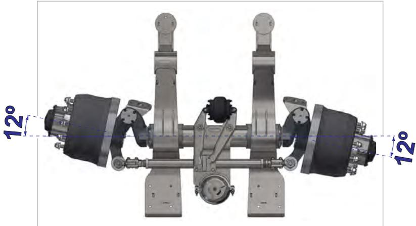
4 EIXOS. 1º EIXO DISTANCIADO DIRECIONAL COM MANGA DE EIXO, ARTICULADAS, COM TRAVA ELETRÔNICA PARA DIRECIONAMENTO DOS PNEUS MEDIANTE O ATRITO COM O SOLO. VANTAGENS QUANTO AO SISTEMA AUTODIRECIONAL COM RALA: APRESENTA MENOR PESO E MAIOR ÂNGULO DE DIRECIONAMENTO DOS PNEUS, FATOR QUE DIMINUI O ARRASTE E CONSEQUENTEMENTE O DESGASTE. SUSPENSÃO PNEUMÁTICA.
