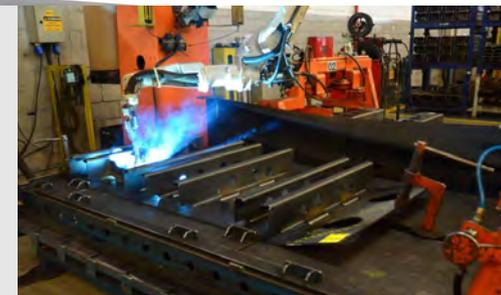
CÉLULA DE MONTAGEM COM SOLDA ROBOTIZADA
