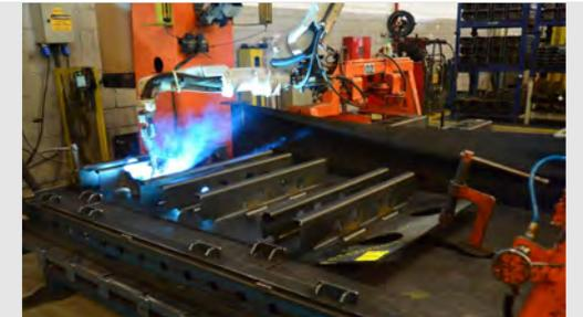
CÉLULA DE MONTAGEM COM SOLDA ROBOTIZADA
