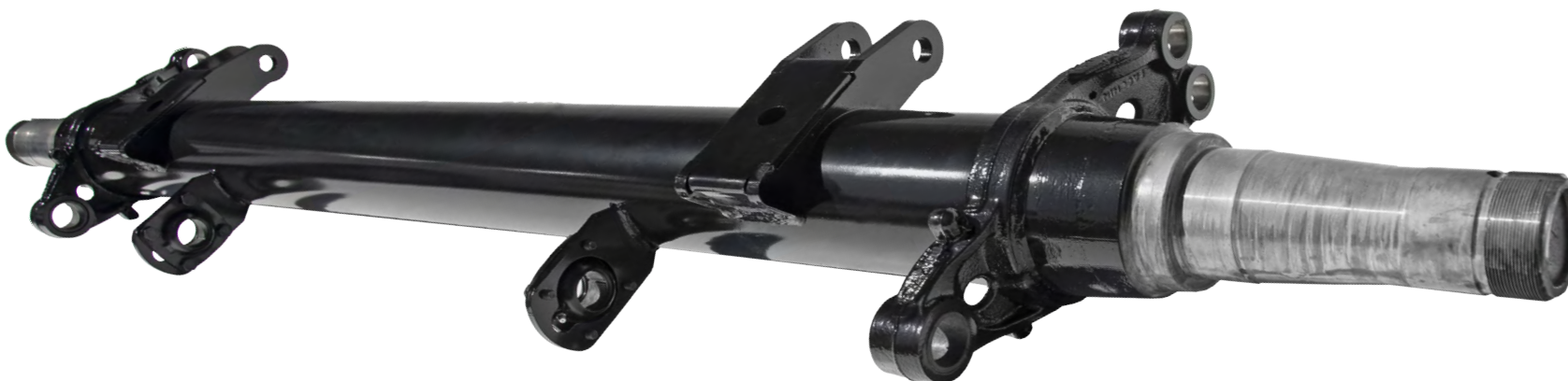
TENDÊNCIA MUNDIAL EIXOS TUBULARES DIÂMETRO DE 152 MM, PAREDE DE 12,5 MM E CAPACIDADE DE 13 T. ALTA RESISTÊNCIA.
