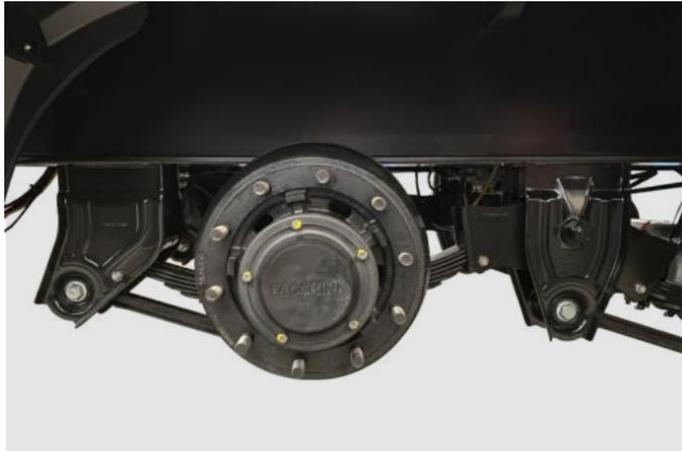
SUSPENSIÓN MECÁNICA TIPO BALANCÍN CON SOPORTES DE RESORTES ESTAMPADOS; RESORTES SEMIELÍPTICOS; BÁSCULA DE ACERO USI SAC 350 ARTICULADAS EN PASADORES Y BUJES CON CUERPO DE POLIURETANO INYECTADO Y TUBO CENTRAL DE ACERO, TENIENDO COMO VENTAJAS UNA MAYOR ABSORCIÓN DE IMPACTOS Y LA ELIMINACIÓN DE LA LUBRICACIÓN. APOYO DE LOS RESORTES TIPO CAMBIO RÁPIDO; BRAZOS TENSORES ARTICULADOS EN BUJES DE GOMA. SUSPENSOR NEUMÁTICO EN EL 1º EJE.
