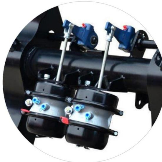
FRENO NEUMÁTICO, CON ABS, LÍNEAS DE SERVICIO Y DE EMERGENCIA, CON TAMBOR 16 1/2" x 8" Y CÁMARA DE FRENO 30 PULG<sup>2</sup> CON SPRING BRAKE | RESOLUCIÓN 915/22 CONTRAN.
