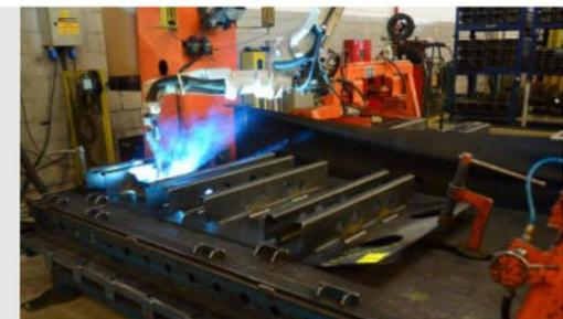
CÉLULA DE MONTAJE CON SOLDADURA ROBOTIZADA
