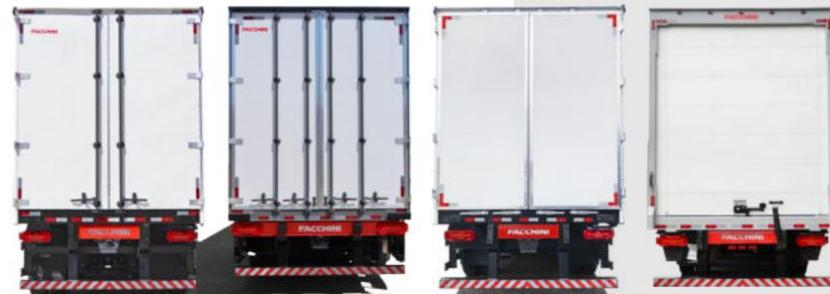
2 PUERTAS TRASERAS DE APERTURA TOTAL, ESTRUCTURADAS EN TUBOS DE ACERO. PERFILES ESTRUCTURALES REVESTIDOS EN CHAPA DE ALUMINIO LISA BLANCA EXTERNAMENTE, CON PERFIL DE DOBLE SELLADO EN EL CONTORNO EN TERMOPLÁSTICO. MODELO: 2 VARONES, 4 VARONES, VARONES EMBUTIDOS Y ROLL UP.
