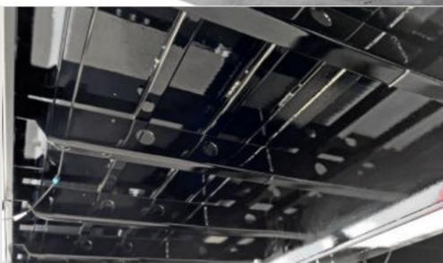
CHASIS CON LONGITUDINALES EN VIGAS PERFIL I DE ACERO DE ALTA RESISTENCIA MECÁNICA, TRAVESAÑAS PASANTES EN PERFIL INTERCONECTADAS A LOS LONGITUDINALES MEDIANTE SOLDADURA ROBOTIZADA Y PASAMANOS EN PERFIL LATERAL DE ACERO ASTM A36.
