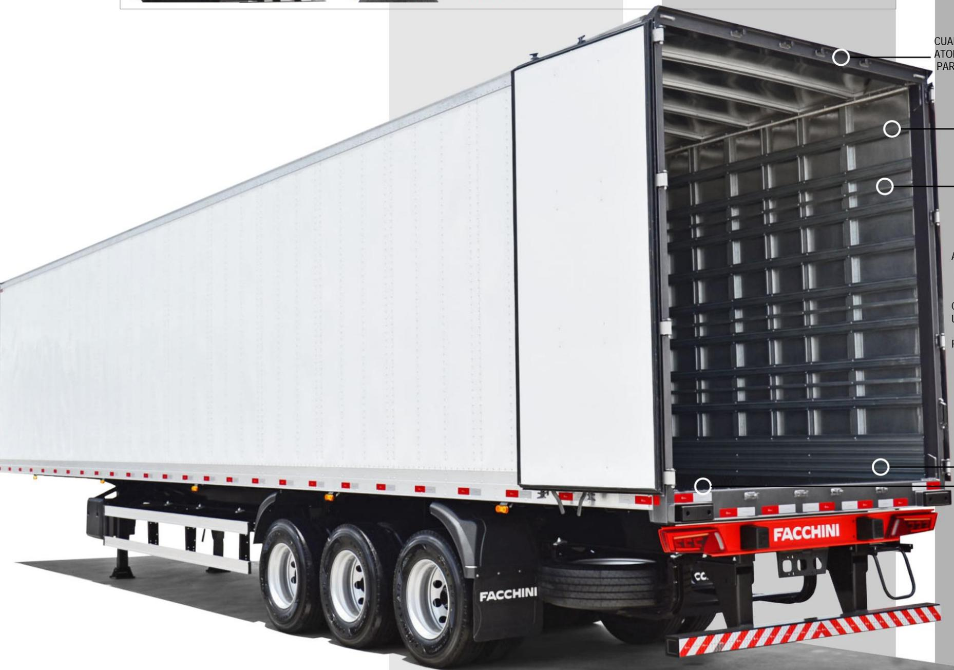
CUADRO TRASERO EN PERFILES DE ACERO ATORNILLADO A LA PLATAFORMA, REFORZADO PARA OPERACIÓN EN MUELLE
