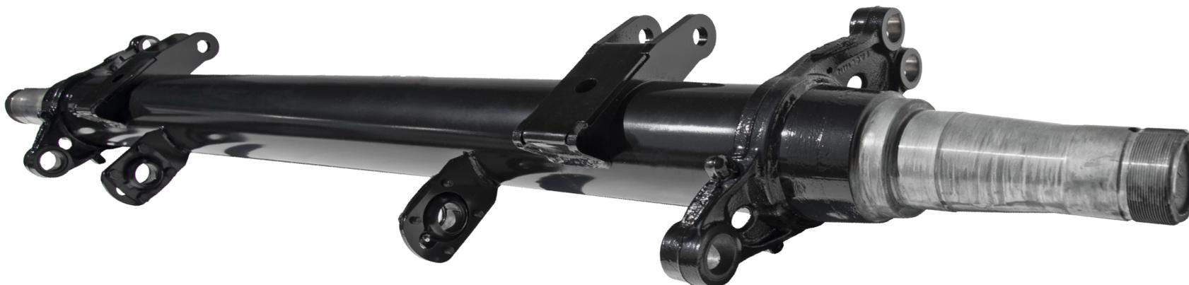
TENDÊNCIA MUNDIAL EIXOS TUBULARES DIÂMETRO DE 152 MM, PAREDE DE 11,2 MM E CAPACIDADE DE 11 T. ALTA RESISTÊNCIA.
