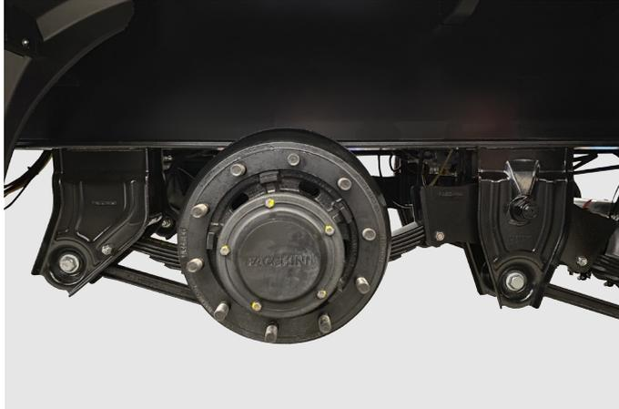
SUSPENSÃO MECÂNICA TIPO BALANÇIM COM SUPORTES DE MOLAS ESTAMPADOS; MOLAS SEMIELÍPTICAS; BALANÇAS AÇO USI SAC 350 ARTICULADAS EM PINOS E BUCHAS COM CORPO EM POLIURETANO INJETADO E TUBO CENTRAL EM AÇO, TENDO COMO VANTAGENS A MAIOR ABSORÇÃO DE IMPACTOS E A ELIMINAÇÃO DA LUBRIFICAÇÃO. APOIO DAS MOLAS TIPO TROCA RÁPIDA; BRAÇOS TENSORES ARTICULADOS EM BUCHAS DE BORRACHA.
