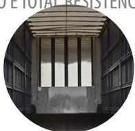
3 COLUNAS MÓVEIS DE AÇO COM ALÇAS POR LATERAL, DANDO SEGURANÇA NA OPERAÇÃO E 2 TRAVAS DE CONTENÇÃO DE CARGA POR VÃO, ENCAIXADAS EM PINOS DE SEGURANÇA.
