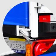
LATERAIS EM LONA VINÍLICA REFORÇADA, SUSTENTADA POR RODÍZIOS SUPERIORES, TRACIONADAS LONGITUDINALMENTE PELA TRASEIRA E NA VERTICAL POR CATRACAS DE POLIETILENO.
