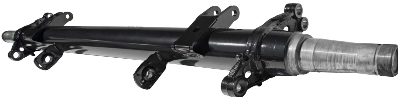
TENDÊNCIA MUNDIAL EIXOS TUBULARES DIÂMETRO DE 152 MM. CAPACIDADE DE 11 T. ALTA RESISTÊNCIA.
