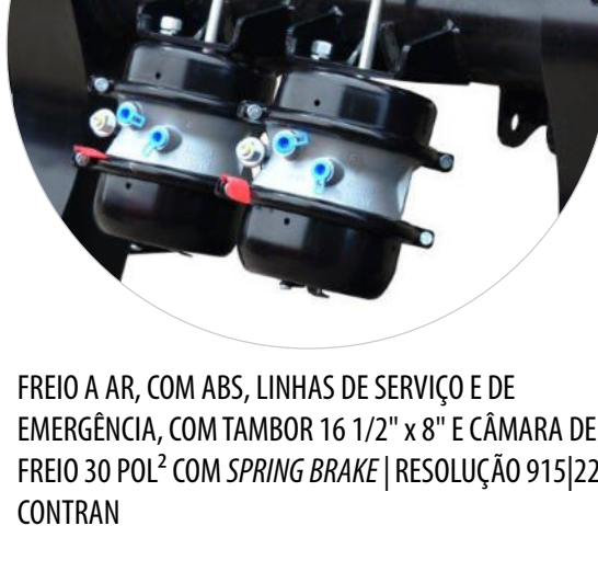
FREIO A AR, COM ABS, LINHAS DE SERVIÇO E DE EMERGENCIA, COM TAMBOR 16 1/2" x 8" E CÂMARA DE FREIO 30 POL" COM SPRING BRAKE | RESOLUÇÃO 915/22 CONTRAN
