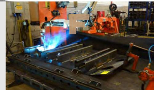
CÉLULA DE MONTAGEM COM SOLDA ROBOTIZADA
