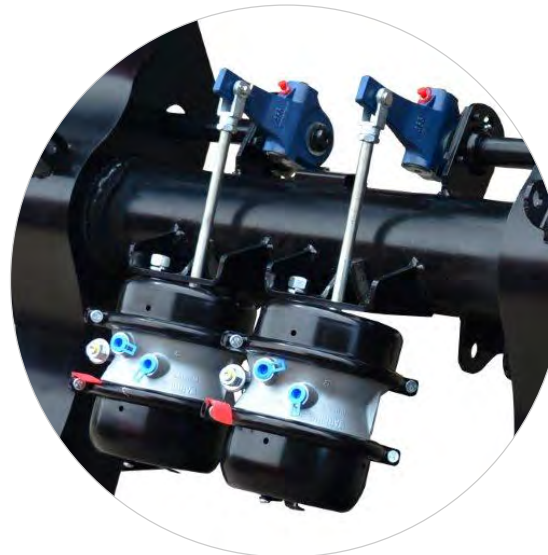
FREIO A AR, COM ABS, LINHAS DE SERVIÇO E EMERGÊNCIA, COM TAMBOR 16 ½" x 8" E CÂMARA DE FREIO 30 POL 2 COM SPRING BRAKE | RESOLUÇÃO 915|22 CONTRAN
