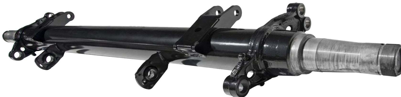
TENDÊNCIA MUNDIAL EIXOS TUBULARES DIÂMETRO DE 152 MM, PAREDE DE 11,2 MM E CAPACIDADE DE 11 T. ALTA RESISTÊNCIA.
