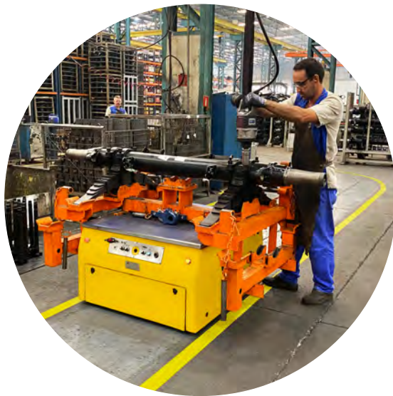
LINHA DE PRODUÇÃO DE MONTAGEM DOS EIXOS
