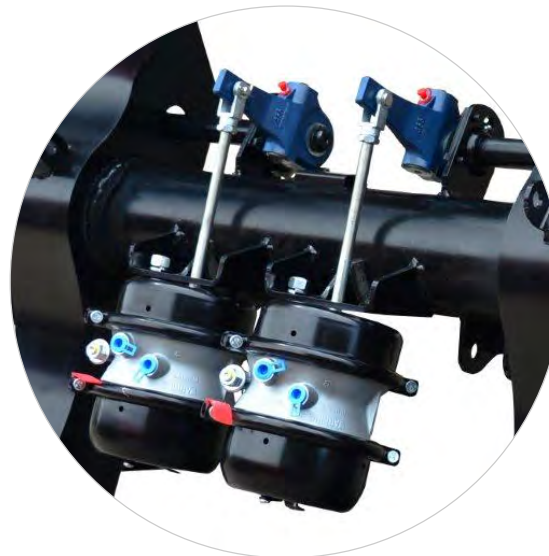
FREIO A AR, COM ABS, LINHAS DE SERVIÇO E EMERGÊNCIA, COM TAMBOR 16 1/2" x 8" E CÂMARA DE FREIO 30 POL 2 COM SPRING BRAKE | RESOLUÇÃO 915|22CONTRAN
