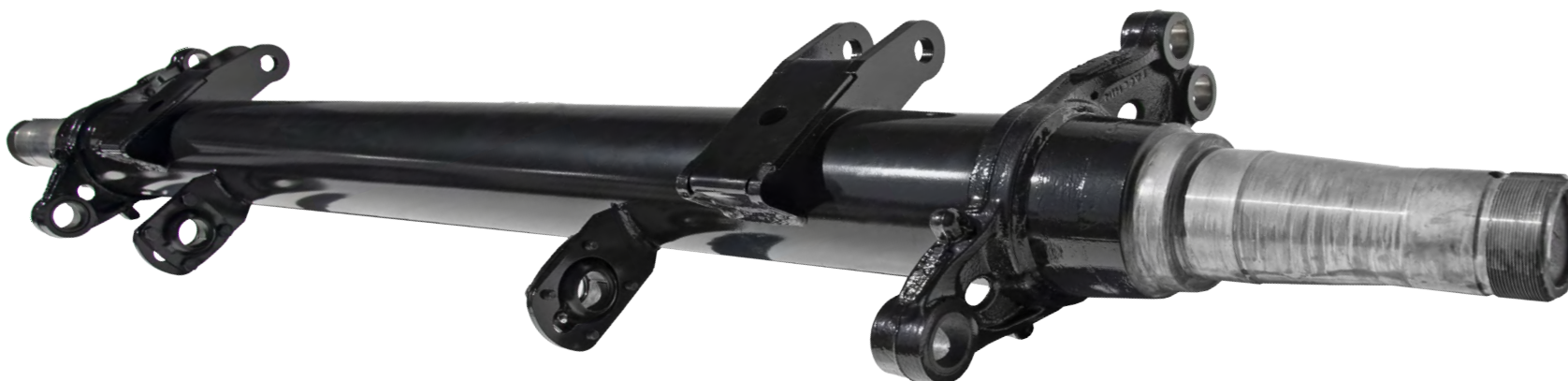
TENDÊNCIA MUNDIAL EIXOS TUBULARES DIÂMETRO DE 152 MM, PAREDE DE 11,2 MM, CAPACIDADE DE 13 T. ALTA RESISTÊNCIA
