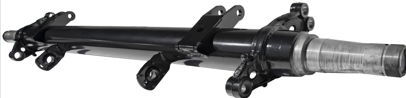
TENDÊNCIA MUNDIAL EIXOS TUBULARES DIÂMETRO DE 152 MM, PAREDE DE 11,2 MM E CAPACIDADE DE 13 T. ALTA RESISTÊNCIA.
